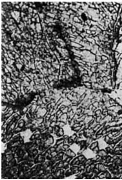
Fig. 2. 75/1 1-n. NaOH, 2 V Badspannung, Raumtemperatur. Orientierte Trocknungsrisse in der oxydischen Deckschicht
